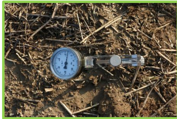
Abb. 13: Messung der Bodenfeuchte mittels Tensiometer (© Schnittstelle Boden)
